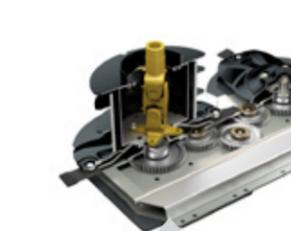
Barra de corte de perfil bajo con transmisión de engranajes dentados
