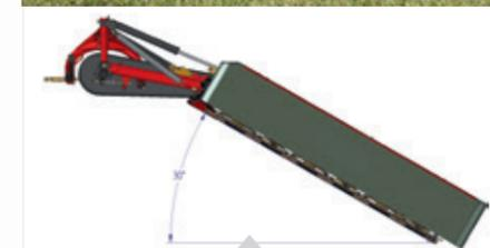
Acoplamiento de enganche lateral: permite segar incluso en terrenos en pendiente
