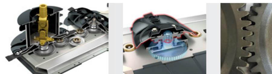
La barra de corte cuenta con un diseño robusto y una larga vida útil que eleva la potencia de la transmisión. Siempre 3,5 dientes en contacto con los engranajes grandes.
