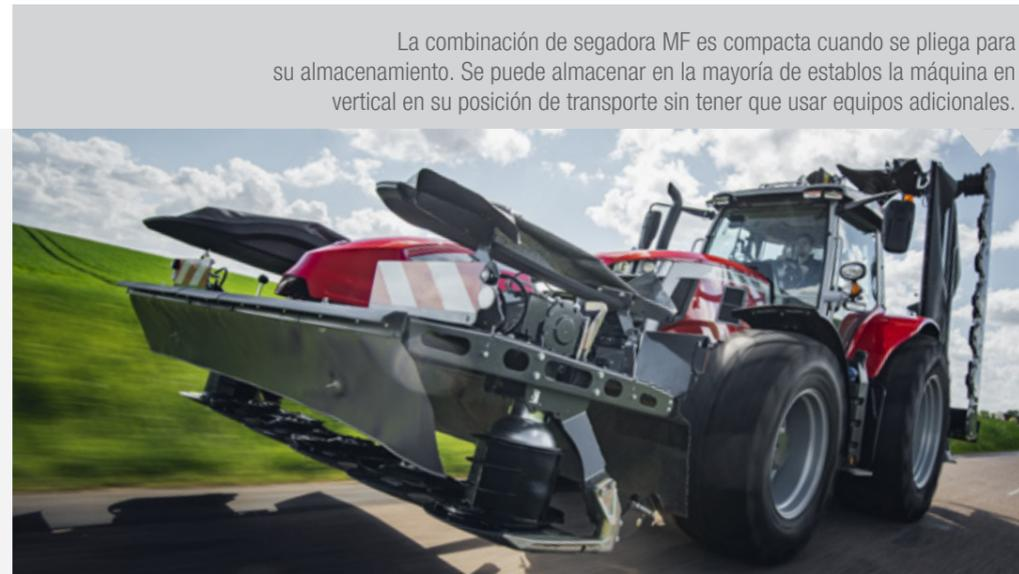
La combinación de segadora MF es compacta cuando se pliega para su almacenamiento. Se puede almacenar en la mayoría de establos la máquina en vertical en su posición de transporte sin tener que usar equipos adicionales.
