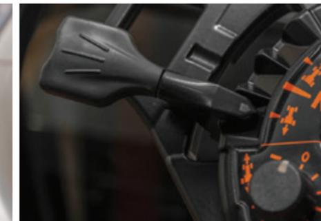
Un **inversor mecánico incorporado de serie** facilita el cambio de dirección, mientras que la **función Power Shuttle opcional** permite controlar con la mano el paso de avance a marcha atrás y viceversa sin necesidad de usar el embrague. Las marchas se cambian con suavidad mediante palancas pulcramente situadas al alcance de la mano del conductor pero sin obstaculizar.
