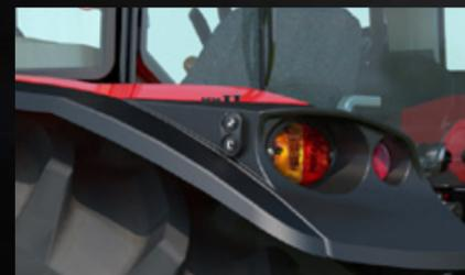
Los controles externos situados en el guardabarros facilitan el manejo del elevador trasero al acoplar o desacoplar aperos de montaje trasero (versiones estándar o de cabina).
