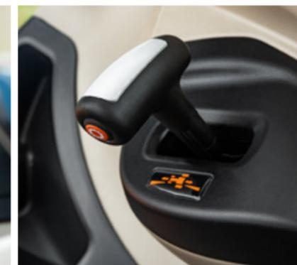
La exclusiva palanca **Power Control** proporciona un funcionamiento «tres en uno» cómodo y simple. Los conductores pueden invertir el sentido de la marcha, cambiar de velocidad o poner punto muerto, quedándoles la mano derecha libre para manipular la pala o los sistemas hidráulicos de los aperos.
