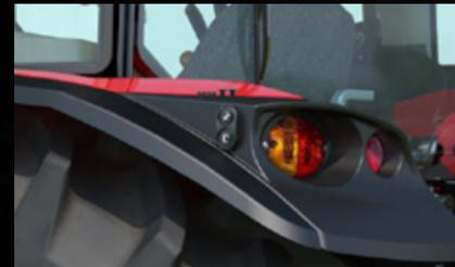
Los controles externos situados en el guardabarros facilitan el manejo del acople trasero al acoplar o desacoplar aperos de montaje trasero.
