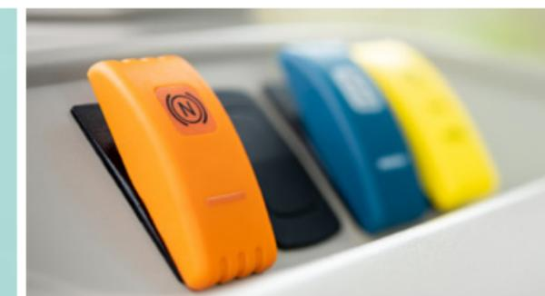
Cuando se activa la **función de freno a neutro**, se acciona simultáneamente el embrague en cuanto se pisa el pedal de freno.
