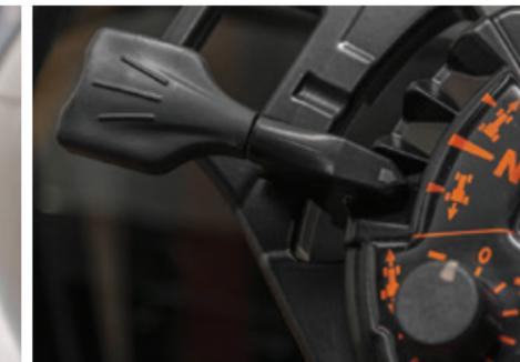
**Power Shuttle** pone en sus manos el control de la transición entre marchas de avance y retroceso, sin usar el pedal de embrague.
