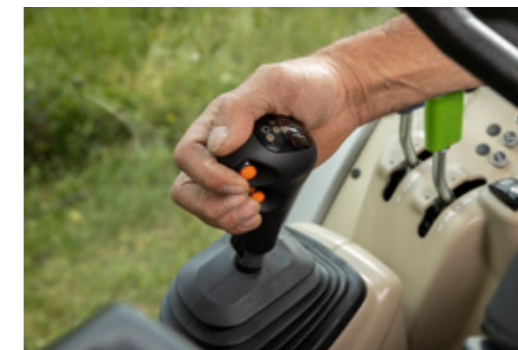
▲ Nueva palanca de cambios con cable bowden para un funcionamiento suave.
