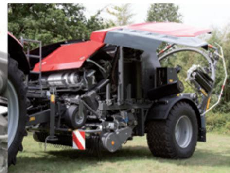
Hay doce soportes de bobinas de película adecuadamente colocados a una altura cómoda a ambos lados de la empacadora, y otros dos adicionales instalados en la encintadora incrementan el tiempo productivo.
