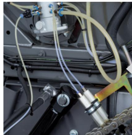
La lubricación automática de las cadenas con ajuste individual para cada cadena garantiza un suministro de aceite suficiente, reduce el tiempo de mantenimiento y amplía la vida útil de la cadena. Para una mayor durabilidad, la empacadora monta unas cadenas de una calidad superior.
