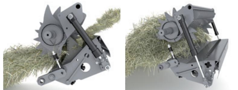
En caso de bloqueo, el operario puede abrir con facilidad el suelo de la mesa de alimentación y bajar las cuchillas al mismo tiempo de forma que haya espacio suficiente para permitir la salida del material.
