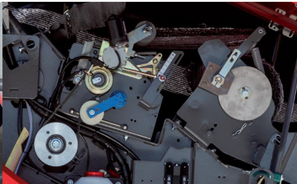
**El sistema de carga fácil**, disponible de serie, permite cargar en la empacadora una bobina de malla adicional. De esta manera, la bobina puede sustituirse en cuestión de minutos para proporcionarle a usted más tiempo en el campo e incrementar la productividad.
