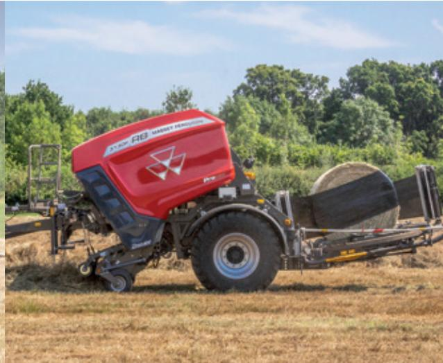
Para garantizar una descarga cuidadosa de las pacas, el plato de encintado desciende para realizar la descarga, minimizando así, la velocidad de rodadura de la paca, evitando dañar la película y preservando una forma ideal. Un volquete opcional coloca las pacas sobre una de sus caras, evitando de esta manera que puedan salir rodando y facilitando su posterior carga en el remolque. El operario puede elegir entre un modo de descarga automático o manual.
