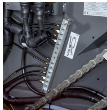
Es extremadamente importante lubricar los rodamientos de forma regular y suficiente, en particular en condiciones adversas, por ejemplo al empacar ensilado. Los puntos de engrase centralizados para la lubricación de los rodamientos de los rodillos están ubicados en posiciones prácticas para ofrecer un acceso más sencillo y reducir el tiempo de mantenimiento.
