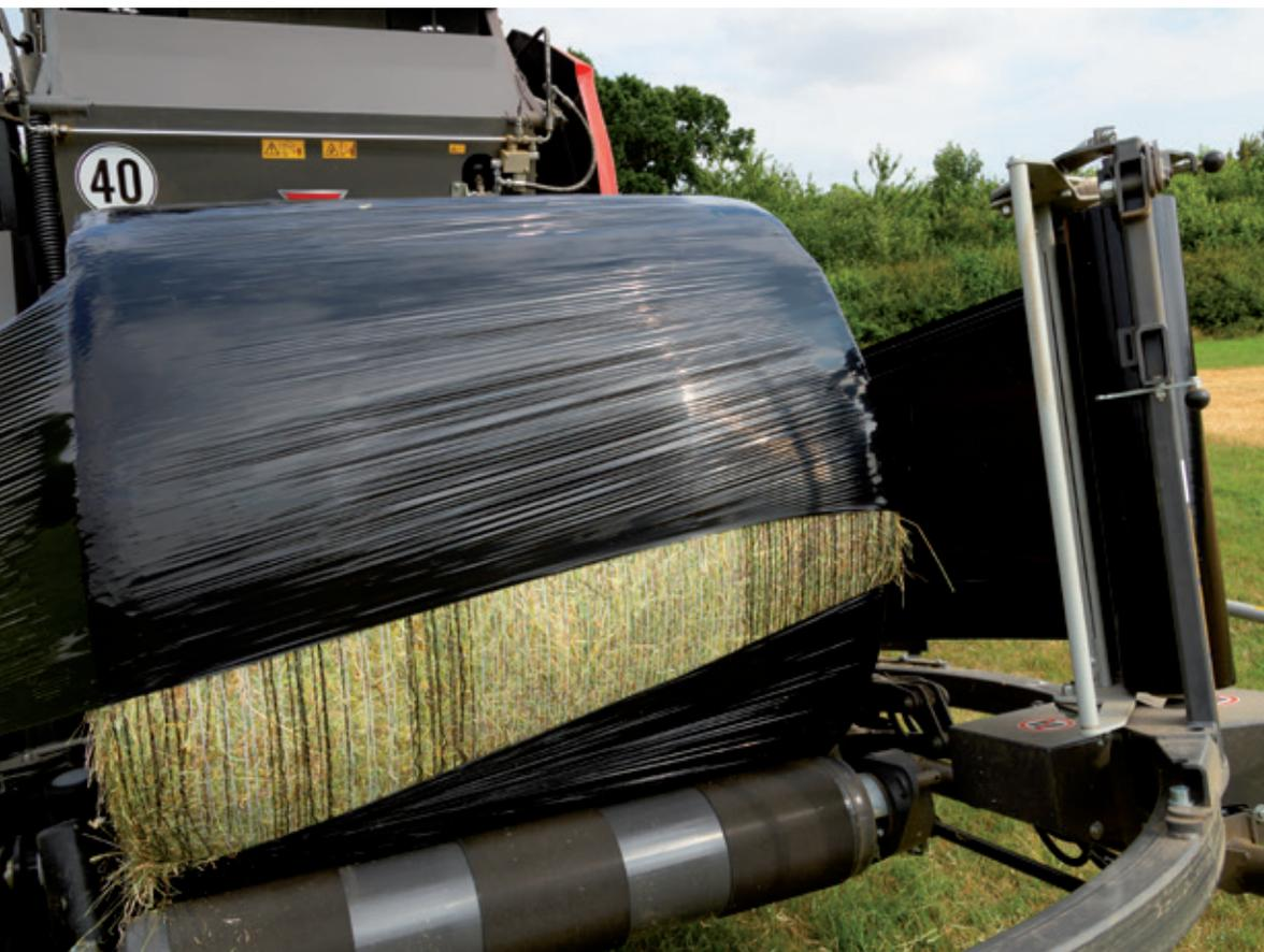
La mesa de encintado de accionamiento hidráulico consta de dos cilindros y tres correas montadas en un bastidor soldado para proporcionar una mayor durabilidad. Un sensor debajo de la correa central permitirá que el encintado dé comienzo únicamente cuando la paca esté totalmente posicionada sobre la mesa, mientras que cuatro rodillos de sujeción laterales mantienen la paca centrada durante el encintado.
