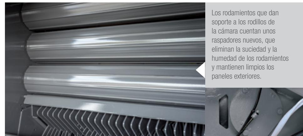
Los rodamientos que dan soporte a los rodillos de la cámara cuentan unos raspadores nuevos, que eliminan la suciedad y la humedad de los rodamientos y mantienen limpios los paneles exteriores.
