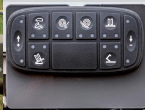
Un panel de control externo en la parte trasera de la roto-empacadora permite controlar el portón trasero, el anillo y la mesa de encintado, y la película se bloquea para facilitar el cambio de rollo, el mantenimiento o la limpieza.
