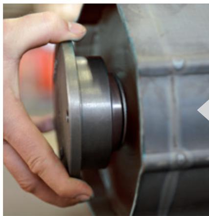
La cámara puede verse sometida a cargas extremas con fuerzas procedentes de todas las direcciones. El inteligente diseño del alojamiento de los rodamientos permite cierto movimiento de los rodillos para eliminar las cargas axiales importantes que se producen durante el funcionamiento.
