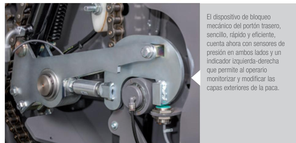
El dispositivo de bloqueo mecánico del portón trasero, sencillo, rápido y eficiente, cuenta ahora con sensores de presión en ambos lados y un indicador izquierda-derecha que permite al operario monitorizar y modificar las capas exteriores de la paca.
